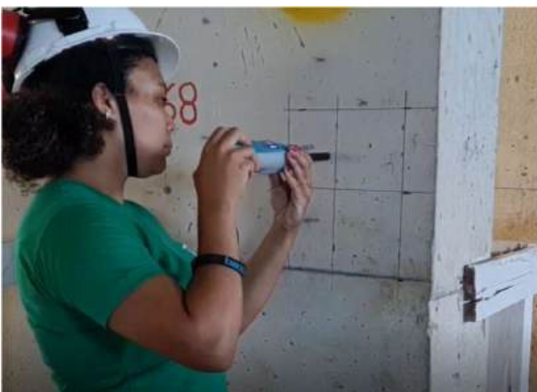
Figura 8. Execução do ensaio de esclerometria em um dos pilares do Bloco 2.
