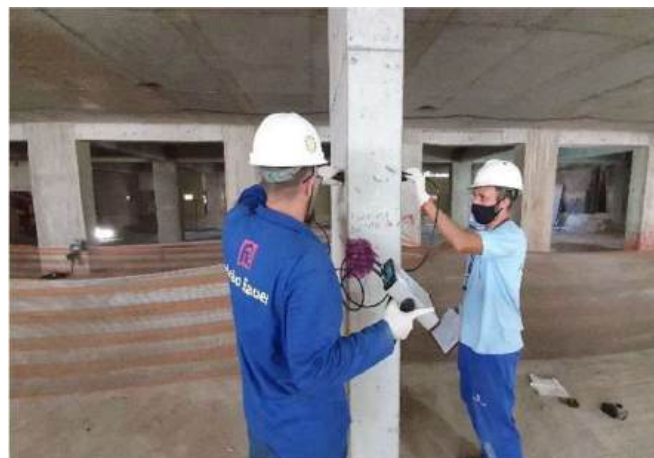
Figura 7. Ensaio de ultrassonografia dinâmica realizado pelo método direto.
