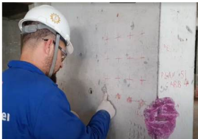
Figura 6. Procedimento do ensaio de ultrassonografia dinâmica em pilar do Bloco 1.
