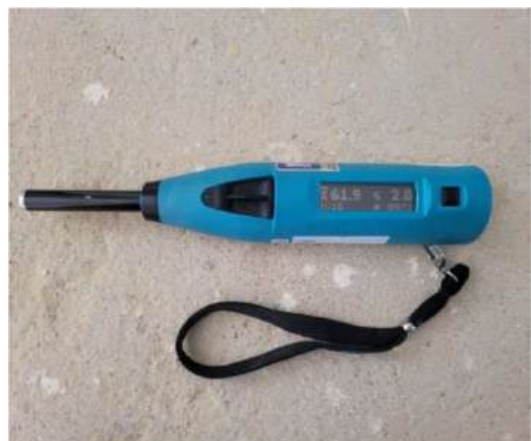
Figura 9. Martelo de Schmidt, equipamento usado no ensaio de esclerometria.
