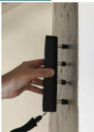
Figura 7. Ensaio de resistividade elétrica. Fonte: Elaboração própria
