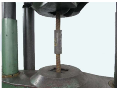
Figura 10b – Barra posicionada na máquina universal durante o ensaio.
