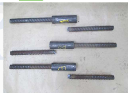
Figura 10c – Barras fraturadas após o ensaio de resistência à tração.
