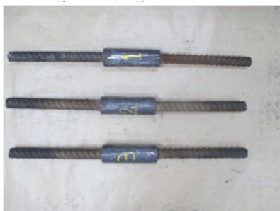
Figura 10a – Barras emendadas pela luva soldável antes do ensaio.
