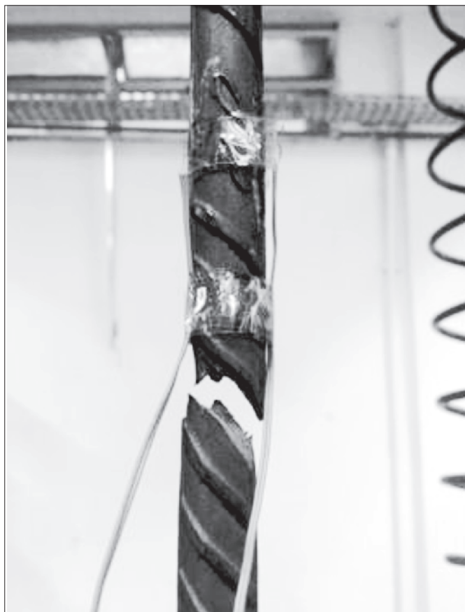
Figure 6 Detalhe da ruptura da barra de controle após ensaio de resistência à tração
