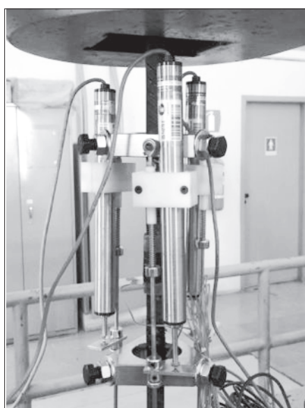
Figura 12 Transdutores em grupos de três instalados às bases triangulares de aço fixas utilizadas no método 3 de ensaio
