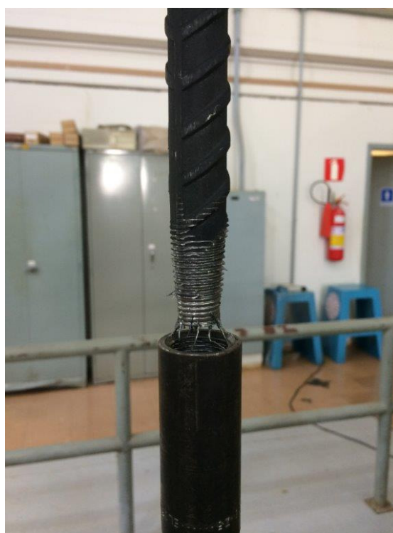
Figura 18 – Detalhe da luva de emenda após ser submetida ao ensaio de resistência à tração e deslizamento.
