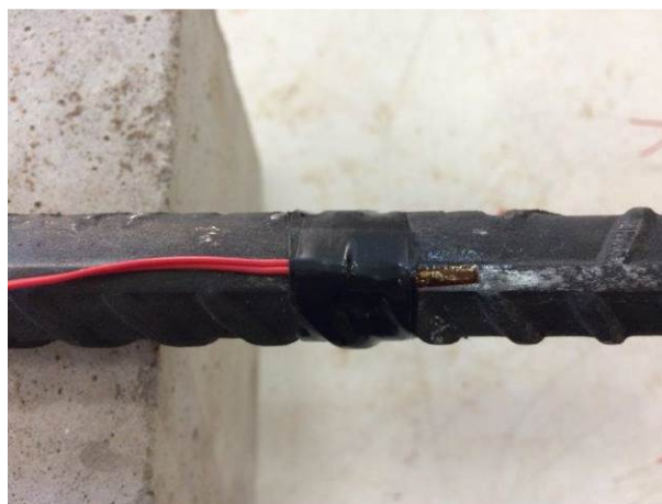
Figura 12 – Strain gage inserido na barra de aço.
