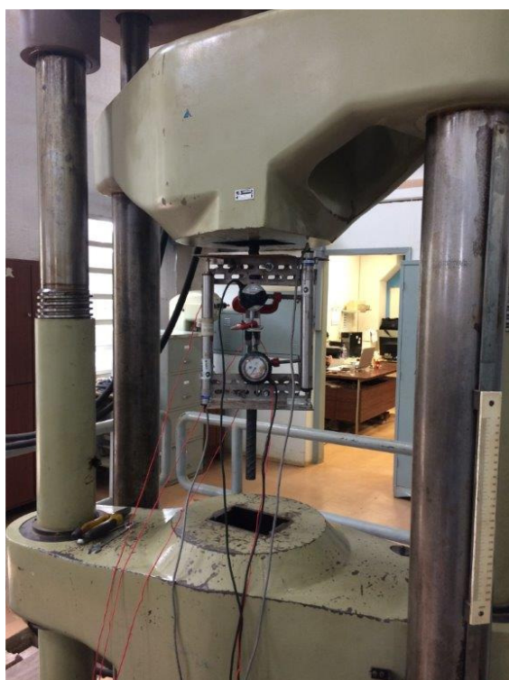
Figura 17 – Luva de emenda devidamente instrumentada e inserida na máquina universal de tração da UNICAMP.
